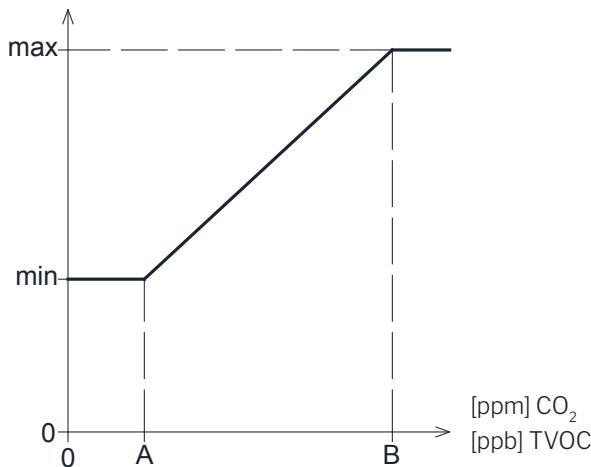
Anlegget kan i utgangspunktet stilles inn til å kjøre med en redusert basis luftmengde (min.) som basisventilasjon.
