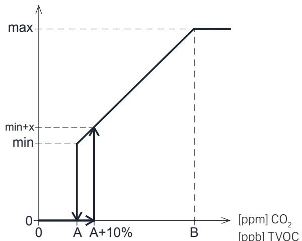
Hvis ventilasjonsanlegget styres helt og holdent av føleren, vil det starte med litt mer enn standard luftmengde (min+x) når CO<sub>2</sub>/TVOC-konsentrasjonen overstiger den programmerte nedre grenseverdien pluss 10 % (A-10 %).
