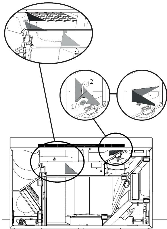
Innblåsningsåpningens lameller kan bøyes litt med f.eks. en spissstang for å tilpasse innblåsningsretningen. Se avsnittet «Justering av lamellene på AM 150, 300, 500 og 800», og «Datablad AM 300»
