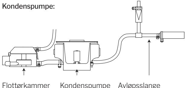
Flottørkammer      Kondenspumpe      Avløpsslange
