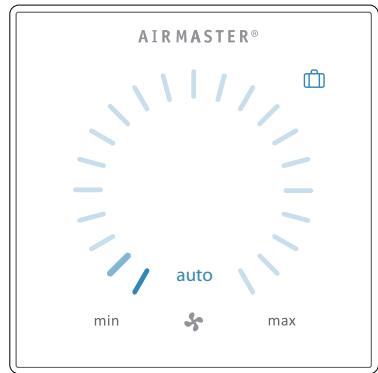
I feriemodus kjører Airmaster-anlegget med minste luftmengde. Den interne styringsfunksjonen «Lav temperatur» er aktiv for å beskytte anlegget mot isdannelse. Styringsfunksjonen kan aktiveres varmeflater om nødvendig. Den interne reguleringsfunksjonen «Høy temperatur» er deaktivert i feriemodus.
