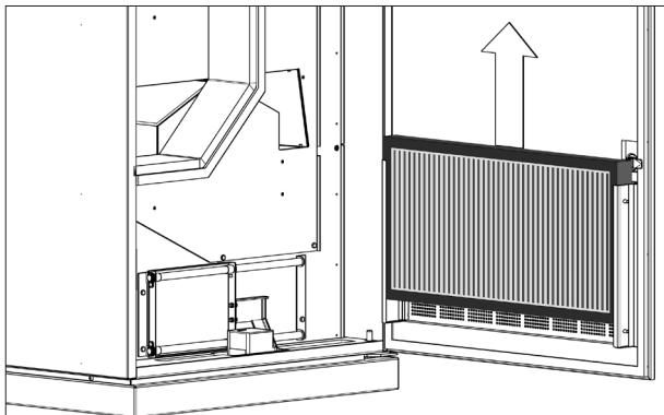
Tilluftsfilteret (1) er montert under en serviceluke og fraluftsfilter (2) er montert med en festeplate.
