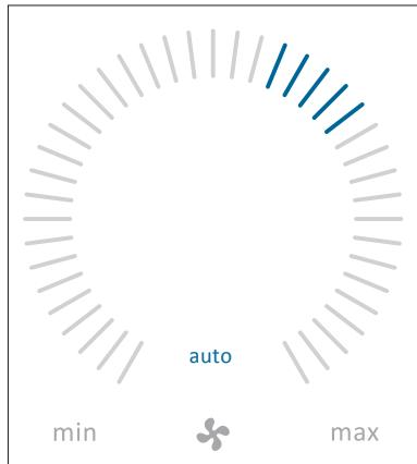
Automatisk drift startes ved hjelp av et ukeskjema, nattkjøling, sensorer, eksterne kontakter eller et analogt BMS-system.
