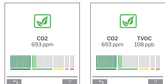
Hvis ventilasjonsanlegget er utstyrt med en CO<sub>2</sub>- eller CO<sub>2</sub>/TVOC-føler, kan rommets reelle inneklimanivå vises på betjeningsdisplayet.
