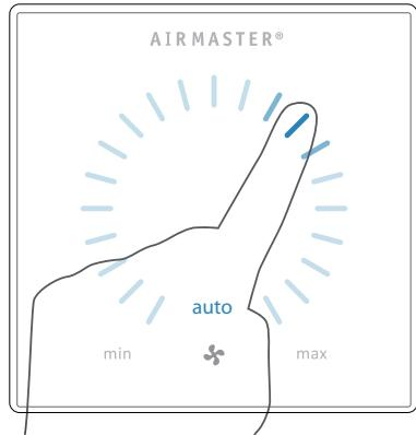
Trykk på den gjeldende luftmengden. Den automatiske betjeningslåsen deaktivertes når luftmengdevisningen markeres opp til den gjeldende innstillingen med blå streker.
