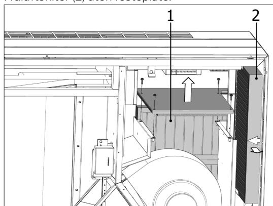
**AM 800V:** To tilluftsfiltere (1) er synlige bak en festeplate under fraluftsfilteret (2) med festeplate.
